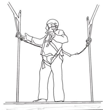
Doppio sistema di collegamento al telaio
