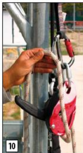
10 - passare la fune scarica che esce dall'I'D nell'apposito corno con leva a filo
