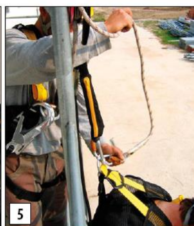
5 - collegare il connettore apertura ghiera gialla nello stesso anello al quale è collegato l'anticaduta dell'infortunato. Recuperare la fune in eccesso.
