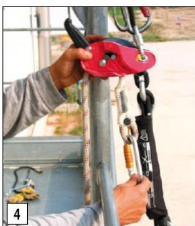
4 - posizionare l'I'D orizzontale per estrarre facilmente la fune
