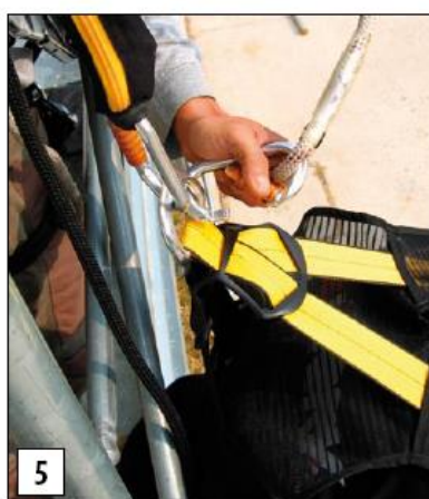
5 - collegare il connettore apertura ghiera gialla nello stesso anello al quale è collegato l'anticaduta dell'infortunato. Recuperare la fune in eccesso.
