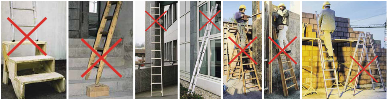
ERRORI COMUNI: Utilizzi non corretti della scala: lunghezze, appoggi, a cavalcioni, scala doppia, sbarco su ponte
