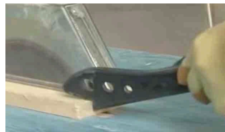
Utilizzare spingitoio per i pezzi piccoli
