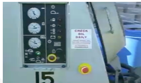
Verifica dei parametri pressione densità e pressione di esercizio e quanto previsto dal libretto
