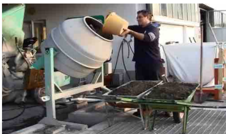
Attivazione macchina e aggiunta di acqua
